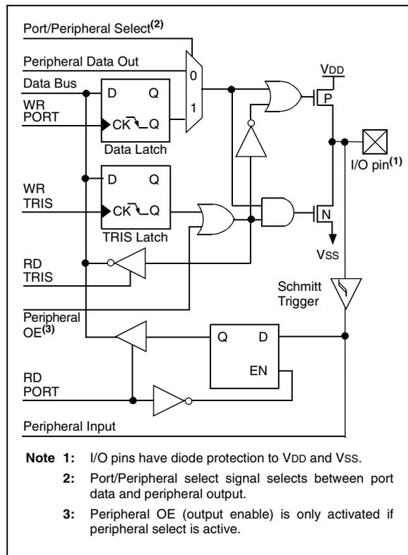
**FIGURE 4-6: PORTC BLOCK DIAGRAM (PERIPHERAL OUTPUT OVERRIDE) RC<4:3>**
